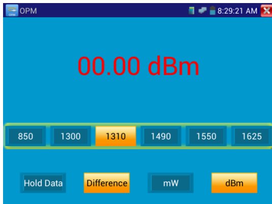
Рис. 3.3.15-2 Измерение относительной оптической мощности
