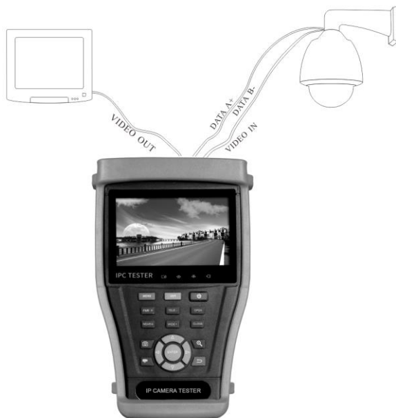
Рис 3.2.2-1 Подключение тестера к аналоговой камере.
