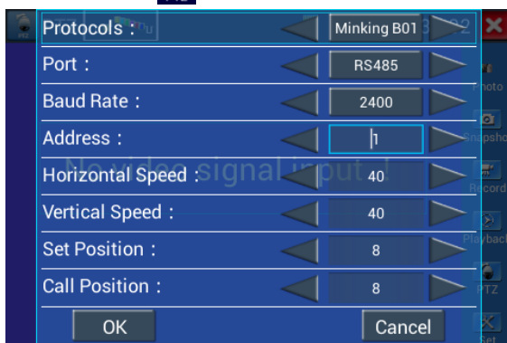
Рис.3.3.1-2 Окно настройки протокола управления камерой (RS485)
