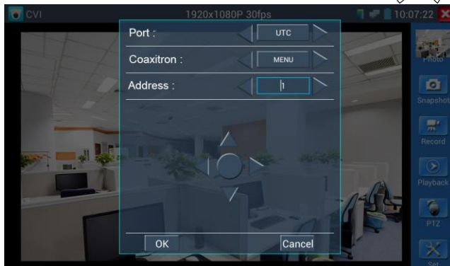
Рис.3.3.6.-5 Установка параметров протокола Coaxitron
