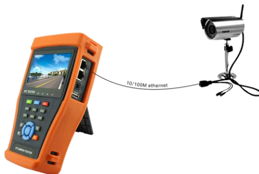
Рис 3.2.1-1. Подключение тестера к IP-камере.
